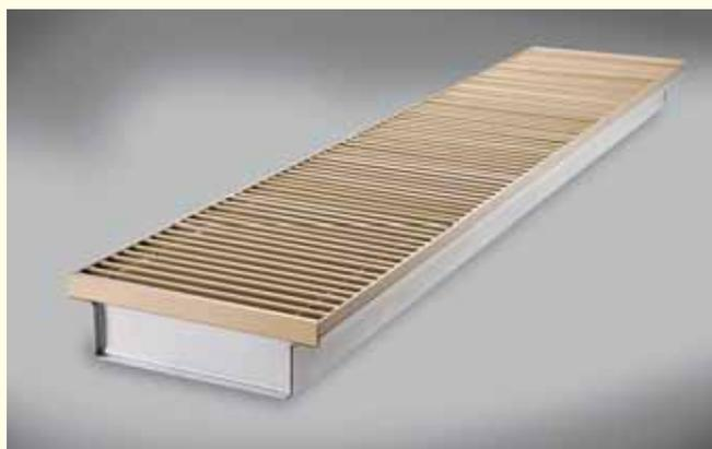
Деревянные решетки изготавливаются из дуба, бука или ясеня. Стандартно дерево решеток покрыто безцветным лаком. Есть возможность изготовить дерево некрашенное (следует указать в заказе). Деревянные решетки изготавливаются только в варианте roll (скатываемые) – в двух вариантах «кость» и «рейка». Промежуток между рейками в деревянных решетках фиксированный – 17 мм для варианта «кость» и – 11 мм для варианта рейка.
