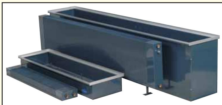
Ширина профиля конвектора, которая формирует короб: 200, 250, 300 или 350мм. Верхняя часть короба конвектора имеет расширение - воротник, на котором держится и в котором установлено обрамление. Общая ширина короба конвектора вместе с воротником соответственно равно: 250, 300, 350 и 400мм.
